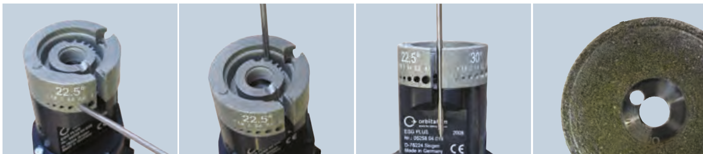
Шлифовальные электроды: – 4 различных угла, 6 различных диаметров электродов
